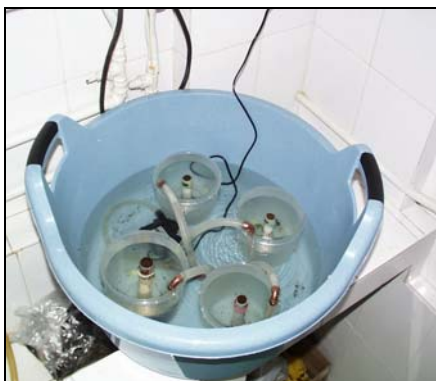
Foto 4.1. Macheta râului artificial, modelul „circular”
